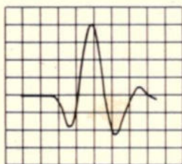
Fig. 4. De gemeten responsie van een luidsprekersysteem van drieduizend gulden bij een ingangssignaal volgens fig. 3a.
